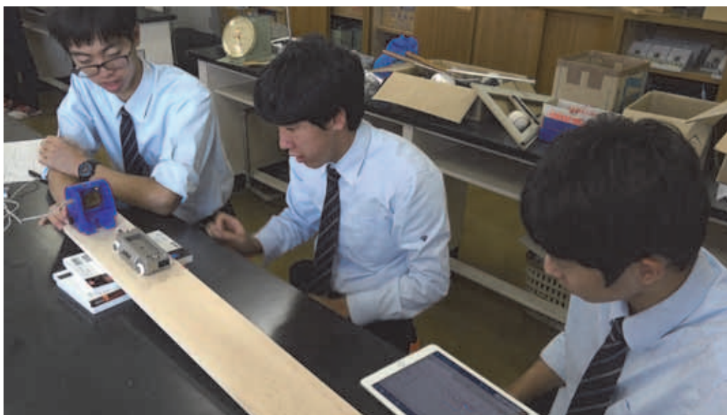
写真1 台車の運動を距離センサで計測
